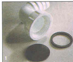
Отводной штуцер до подключения шланга закрывают резиновой шайбой, вставленной вместо уплотнительного кольца.
