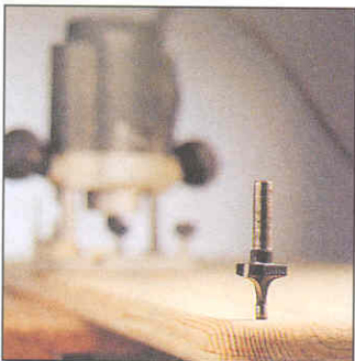
Ребра щита — будущего сиденья скамьи — скругляют с помощью фрезерной машинки с галтельной фрезой.
