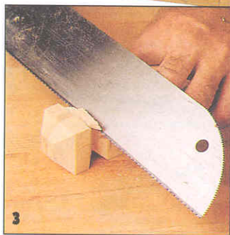
Декоративные канавки на стойках и царгах вырезают мелкозубой пилой по разметке. Для ускорения работы заготовки можно соединить в пакет.
